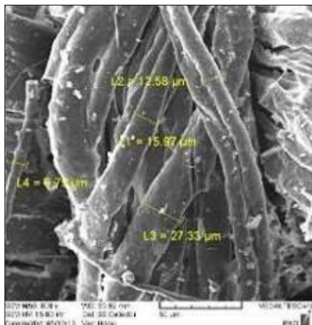
شکل ۹: تصویر SEM از الیاف کاغذ با بزرگنمایی ۸۰۰ برابر
