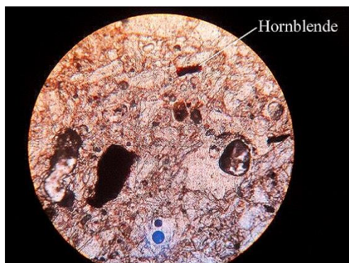
شکل ۲۳: کانی هورنبلند و هوازدگی اطراف آن، بزرگنمایی 100X حالت SPL Fig; 23: Hornblende mineral and weathering around it, 100x, SPL mode
