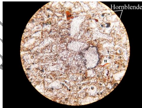
شکل ۲۲: کانی هورنبلند، بزرگنمایی، 100X حالت SPL Fig; 22: Hornblende mineral, 100x, SPL mode
