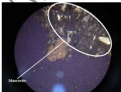
شکل ۱۹: کانی مسکوویت، بزرگنمایی 100X حالت PPL Fig. 19: Muscovite mineral, 100x, PPL mode
