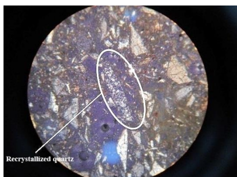
شکل ۱۶: حضور ذرات کوارتز و خطوط شکستگی در بین آن‌ها، بزرگنمایی 100X حالت PPL شکل ۱۷: کوارتز باز تبلور شده، بزرگنمایی 100X حالت PPL Fig. 16: The presence of quartz particles and fracture lines among them, 100x, PPL mode Fig. 17: Recrystallized quartz, 100x, PPL mode
