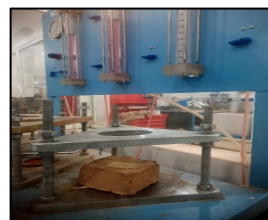
شکل ۱۸: آزمایش نفوذ پذیری نمونه H
