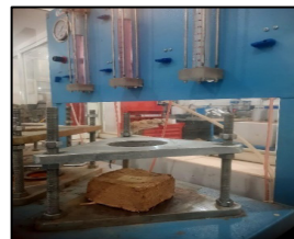
شکل ۱۸: آزمایش نفوذ پذیری نمونه H
