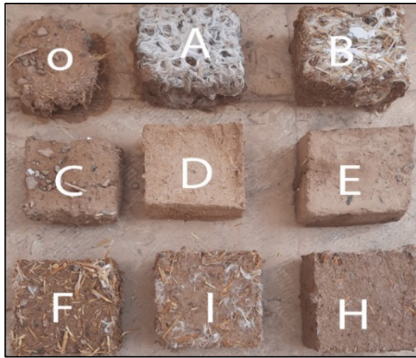
شکل ۱۰: نمونه‌ها بعد از انجام آزمایش آبشویی
