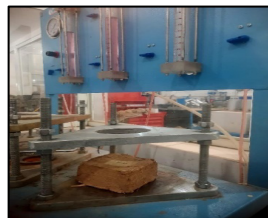
شکل ۱۸: آزمایش نفوذ پذیری نمونه H
