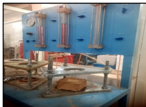
شکل ۱۷: آزمایش نفوذ پذیری نمونه D
