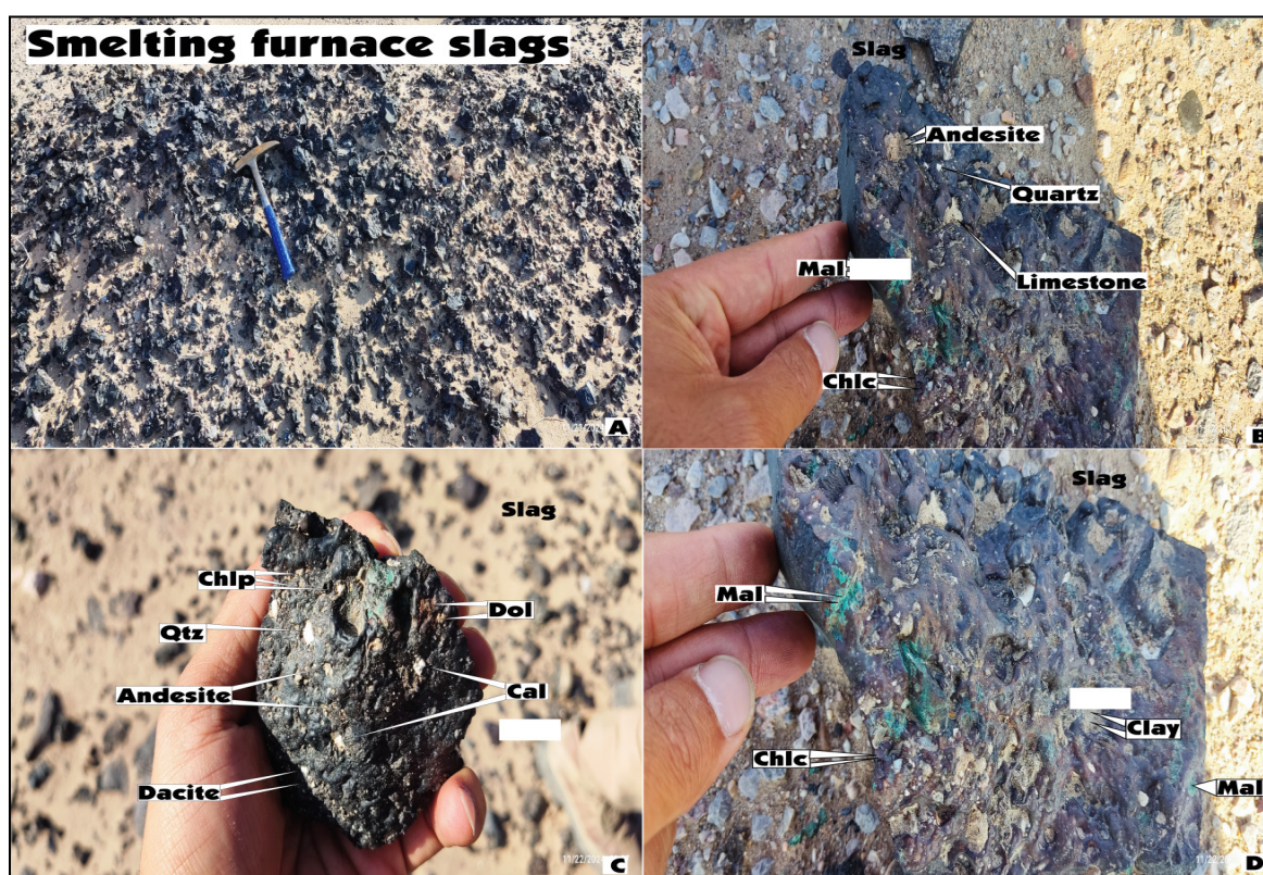
شکل ۸. فراوانی (A) و چند نمونه دستی از سرباره‌ها و قطعات موجود در این بقایای ذوب (B, C, D) که به صورت سنگ شناسی و کانی‌ها مشخص شده‌اند و کانی‌های مس‌دار در آن (B, C) مشخص شده است.
