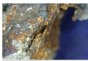
شکل ۱۴. رسوبات نارنجی لایه‌ای Figure. 14. Layered orange sediments
