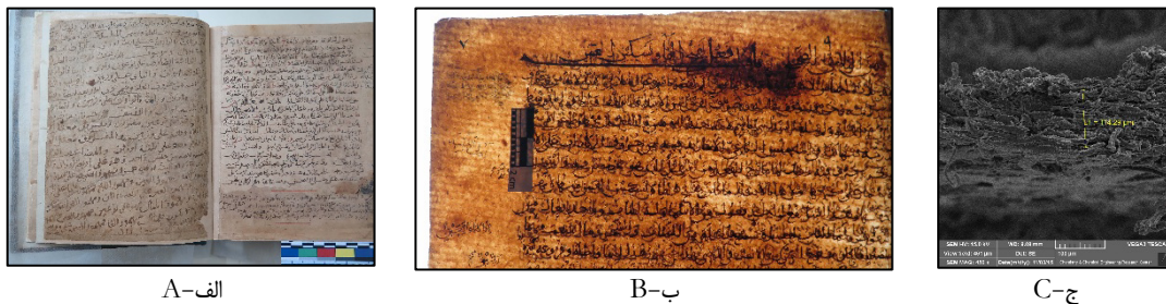
شکل ۱. کاغذ دولت‌آبادی D-345: الف) کاغذ به رنگ کرمی؛ ب) عدم یکنواختی یکنواخت خمیر کاغذ، انحراف خطوط
