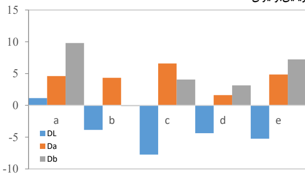
شکل ۷. تغییر مؤلفه‌های رنگ سنجی: نمونه بدون تیمار در قبل و بعد از پیرسازی (a)، نمونه تیمار شده با تیمار ۱ درصد پلی‌وینیل‌بوتیرال در قبل و بعد از پیرسازی (b)، نمونه تیمار شده با مخلوط ۱/۵، ۱/۵ درصد پلی‌وینیل‌بوتیرال و پارالوئید B-72 در قبل و بعد از پیرسازی (c)، نمونه تیمار شده با پلی‌وینیل‌بوتیرال ۳ درصد در قبل و بعد از پیرسازی (d)، نمونه تیمار شده با پلی‌وینیل‌بوتیرال ۵ درصد در قبل و بعد از پیرسازی (e).
