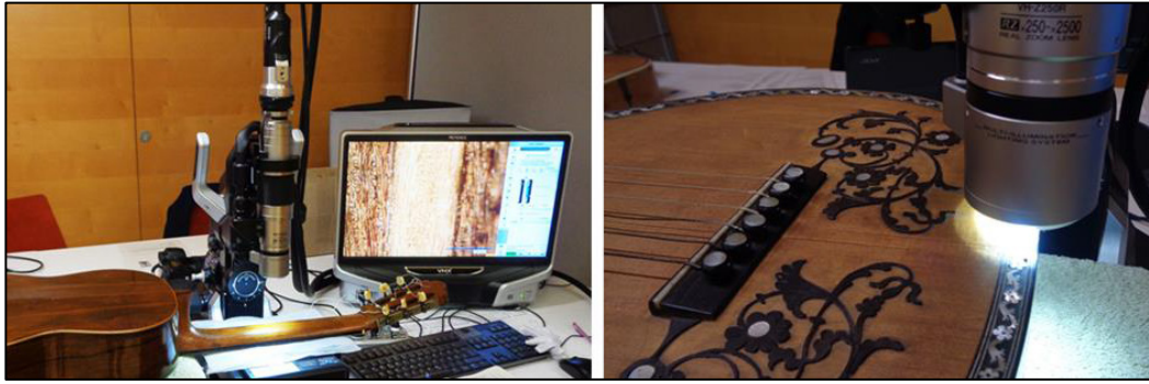
شکل ۳. بررسی ساز گیتار تاریخی با سیستم تجزیه و تحلیل تصویر میکروسکوپ دیجیتالی (Cell ^ F®, Olympus and KEYENCE® VHX-5000) (Haag et al, 2017, p. 106)
