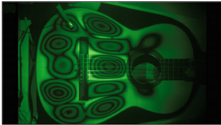
شکل ۷. هولوگرافی تداخل‌سنجی متوسط، لرزش تخته‌ی صوتی گیتار در فرکانس بالاتر از ۱۱۰۰ Hz (a). این روش برای نشان دادن تأثیر طراحی مهاربندی در پشت صفحه‌ی گیتار (b) برای ارزیابی کیفیت صدای گیتارها استفاده شده است (Richardson, 2010, p. 127)
