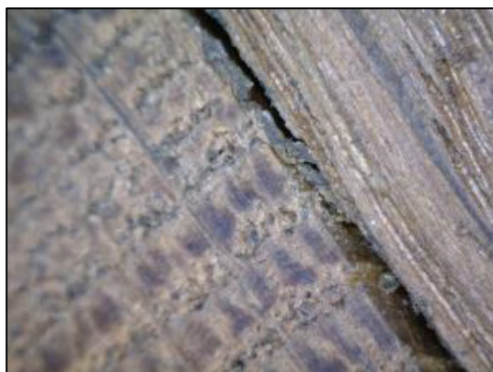
شکل ۲. بخشی از صفحه‌ی صوتی ۶ اینچی ساز هارپسیکورد تاریخی. Quercus sp. - مرزهای حلقه رشد متمایز، حلقه چوب متخلخل، آوندها در طرح دندریتیک، ارتفاع پرتو بیشتر از ۱ میلی متر. بخشی از صفحه صدای هارپسیکورد (Vandervellen, 2017, p. 103).
