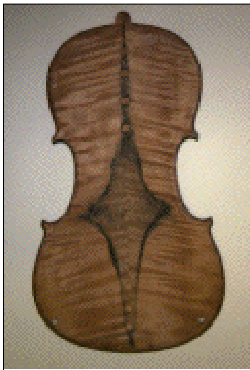
شکل ۶. مد فرکانسی ایجاد شده بر روی صفحه‌ی ویلن ساخته شده در حدود سال ۱۸۷۰ در آلمان. روی صفحات ویلن از ماسه‌ی سیاه استفاده شده است. این آزمایشات توسط E Bossy و R Carpentier در دانشگاه سافت ولز استرالیا انجام گرفته است (Molin, N. E et al, 1988) Figure 6. Frequency mode pattern generated on the soundboard of a violin made around 1870 in Germany. Black sand was used on the violin plates. These experiments were conducted by E. Bossy and R. Carpentier at the University of South Wales, Australia. (Molin, N. E. et al., 1988).
