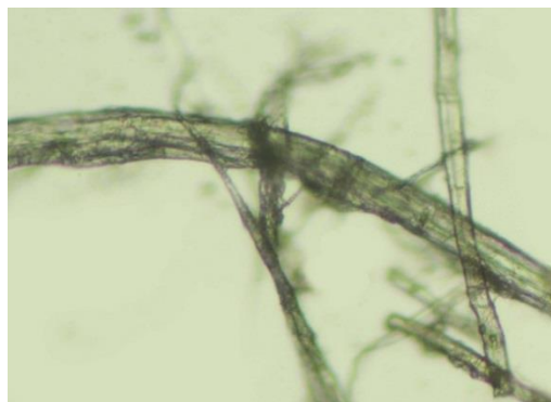
شکل ۲: تصویر میکروسکوپی الیاف اوراق نسخه خطی-بزرگنمایی \times 200 .
