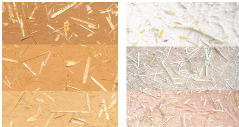
شکل ۴: تنوع رنگ خاک در پوشش مقاوم کاهگلی ضد آب
