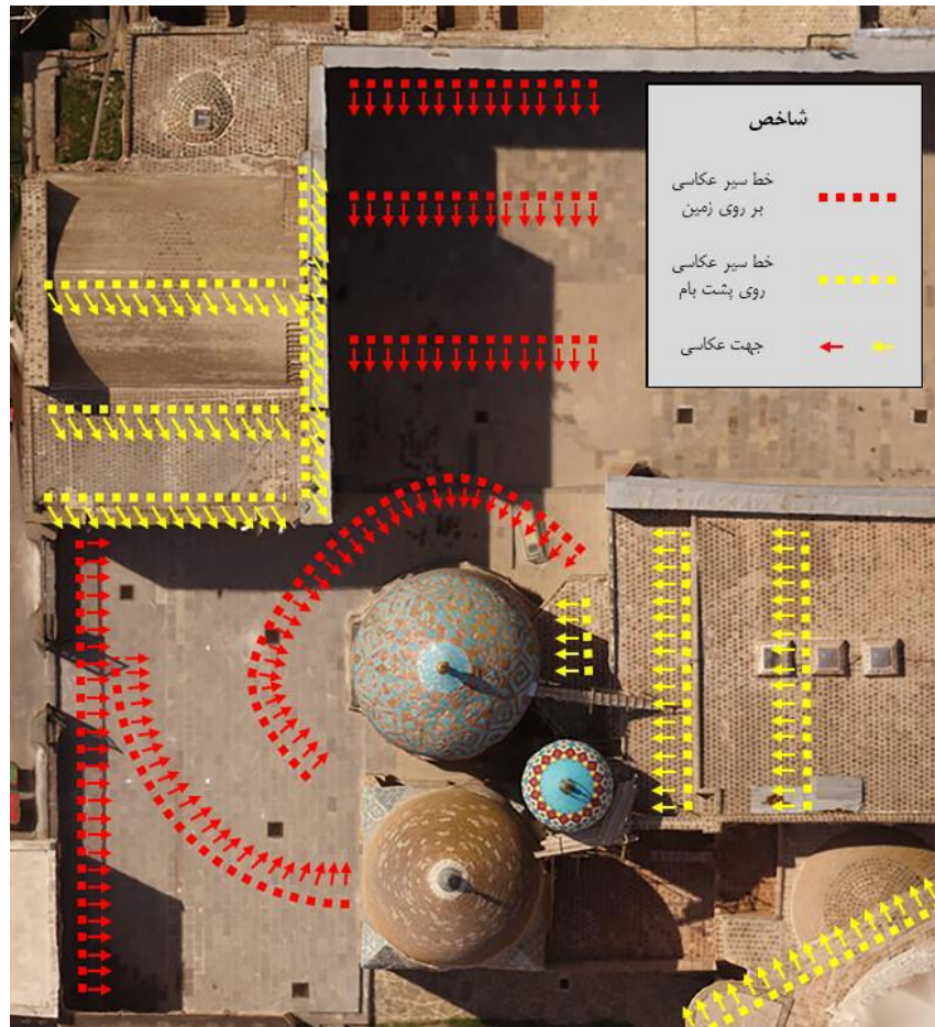
شکل ۳: محل برداشت هفتصد عکس به محوریت گنبد الله الله (تصویر زمینه: تصویر تخت محوطه بقعه، تولید شده از عکس‌های هوایی) Fig: 3: Places that seven hundred shots has been taken from Allah Allah dome (Background: non-perspective image of the complex made by aerial shots)
