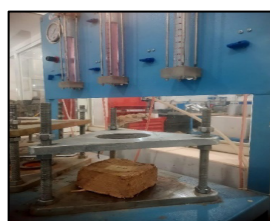
شکل ۱۸: آزمایش نفوذ پذیری نمونه H
