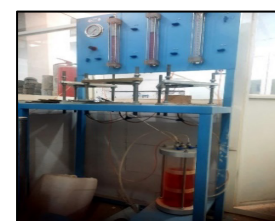
شکل ۱۹: آزمایش نفوذ پذیری خشت اولیه
