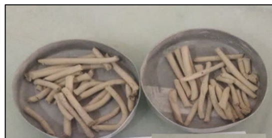
شکل ۷: تعیین حد خمیری نمونه ها (آزمایشگاه خاک و مکانیک استان اصفهان، ۱۴۰۳)
