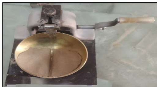
شکل ۶: تعیین حد روانی نمونه ها (آزمایشگاه خاک و مکانیک استان اصفهان، ۱۴۰۳)
