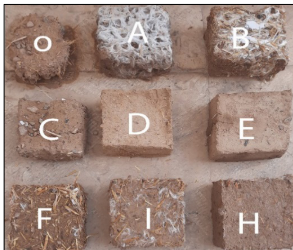
شکل ۱۰: نمونه ها بعد از انجام آزمایش آبشویی
