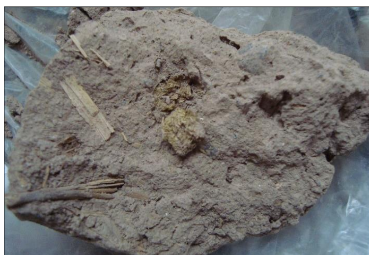
شکل ۴: وجود اجزای زائد (خاشاک و فضولات حیوانی) در نمونه خشت H3.
