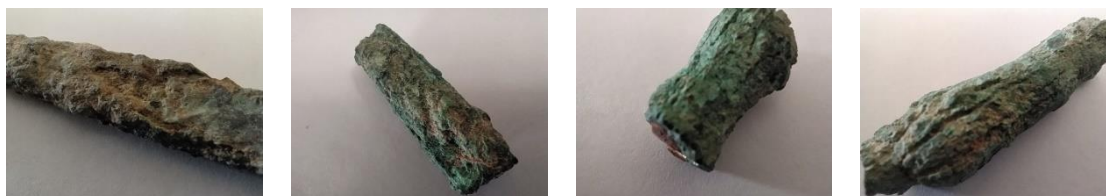
شکل ۳: رسوبات سطحی، خوردگی نمونه ها به رنگ سبز روشن، سبز تیره، آبی و قرمز قهوه ای در سطح اصلی
