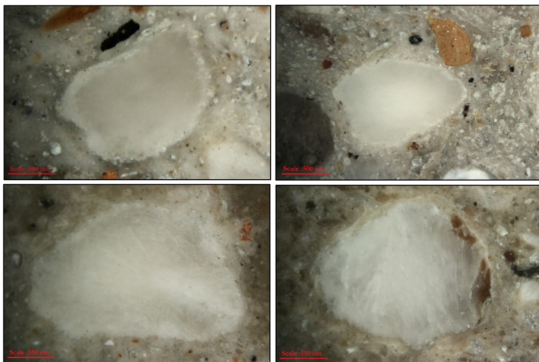
شکل ۱۲. ذرات درشت‌دانه و گردگوشه کلسینه نشده به ابعاد ۱/۵ تا ۲ میلی‌متر در نمونه‌های:
