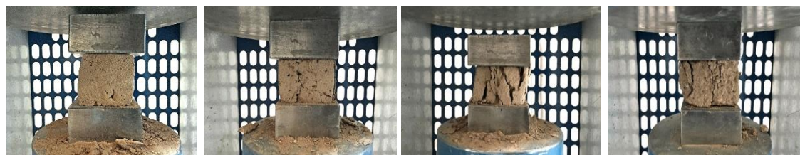
شکل ۶: نمونه‌های مکعبی تحت آزمون مقاومت فشاری
