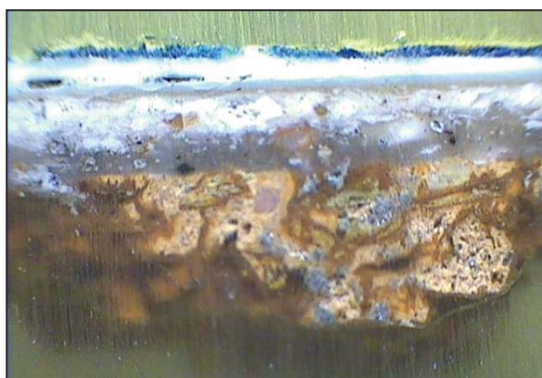
تصویر ۶. تصویر از مقطع لایه آستر و لایه‌های دوم و سوم بستر
