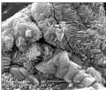
تصویر (۸): SEM از نمونه شاهد در برابر محلول خورنده سدیم کلرید ۰/۵M
