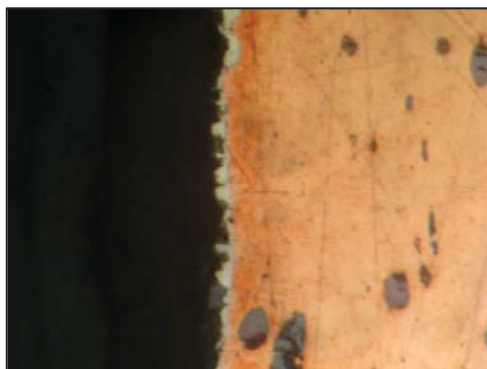
شکل ۱۰- تصویر میکروسکوپی مقطع بدنه ظرف مسی قلع‌اندود تاریخی، بزرگنمایی \times 500 ، فاز \eta با رنگ روشن
