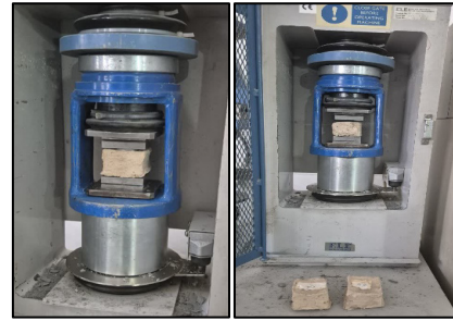
شکل ۱۶: جک ملات شکن جهت بررسی مقاومت فشاری نمونه ها
