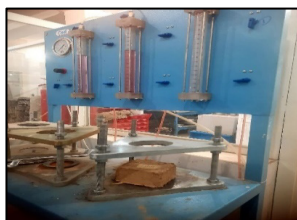
شکل ۱۷: آزمایش نفوذ پذیری نمونه D
