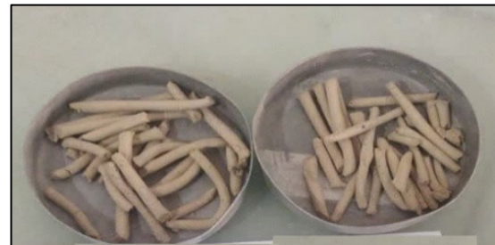
شکل ۷: تعیین حد خمیری نمونه ها (آزمایشگاه خاک و مکانیک استان اصفهان،
