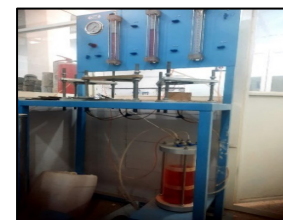
شکل ۱۹: آزمایش نفوذ پذیری خشت اولیه
