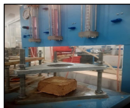
شکل ۱۸: آزمایش نفوذ پذیری نمونه H
