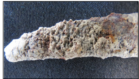
شکل ۸. خوردگی به شکل حفره
