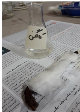
شکل ۲۹. ضمادگذاری با کالگن برای برداشتن لایه‌های خوردگی Figure. 29. Poultice with Calgon to remove corrosion layers
