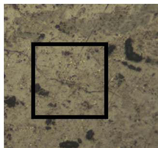
شکل ۲۱. وجود فریت صفحه‌ای نامنظم (بزرگنمایی ۱۰۰ برابر)
