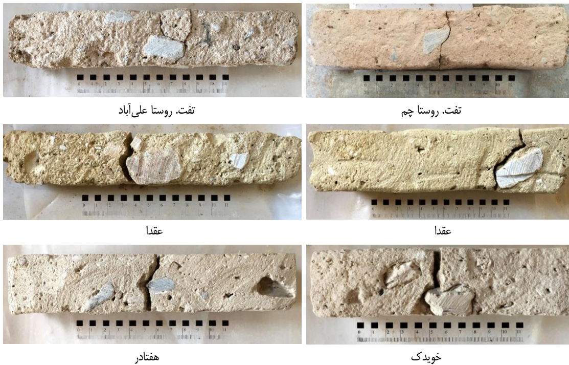
شکل ۳: مسیر شکست در نمونه های منشوری تحت آزمون مقاومت خمشی
