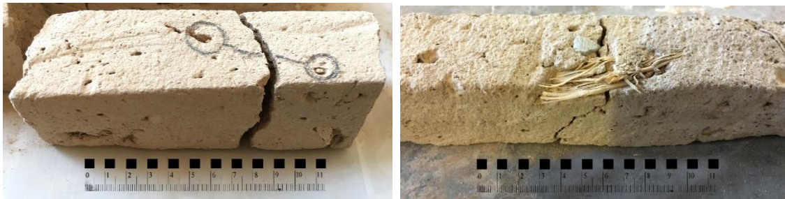
شکل ۴: اتصال قطعات خشت توسط الیاف گیاهی پس از شکست در آزمون مقاومت خمشی (چپ: همت‌آباد- راست: سریزد)
