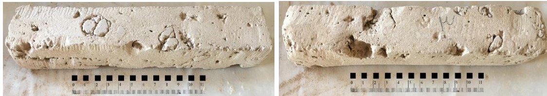
شکل ۵: کلوخه‌های رسی غیرمنسجم (مجومرد، نمونه ۲)
