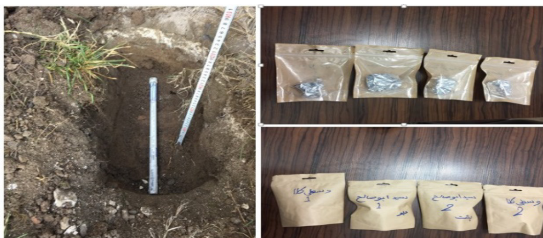
شکل ۴. تصاویر دفن دزیتر نمونه‌های تهیه‌شده از آجرهای پی سقانه‌فراها.
