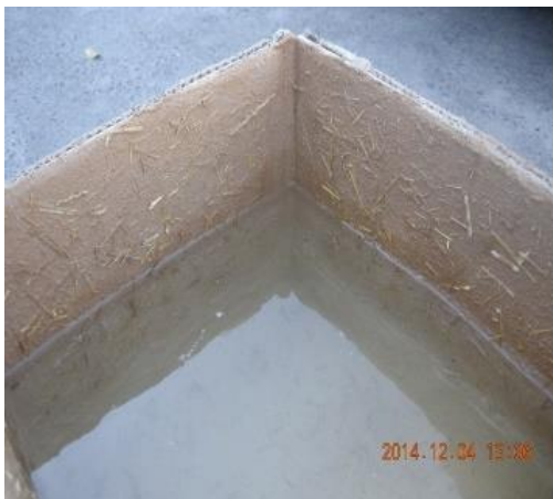
شکل ۶: نفوذناپذیری در برابر تماس رطوبت پوشش مقاوم کاهگلی ضد آب بر روی سطح کارتن مقوایی
