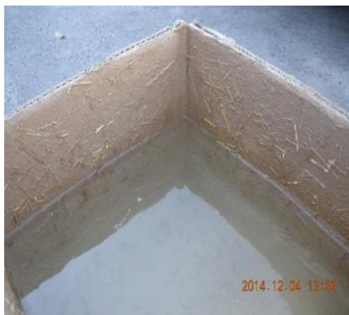
شکل ۶: نفوذناپذیری در برابر تماس رطوبت پوشش مقاوم کاهگلی ضد آب بر روی سطح کارتون مقایی
