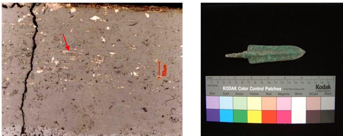
شکل ۵: تصویر میکروسکوپ نوری از ناخالصی‌های جهت‌دار در نمونه ۵ (برداشت نمونه از خوردگی‌های لبه اثر)
