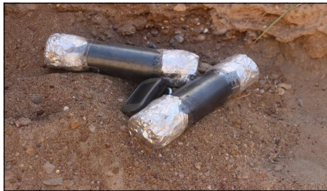
شکل ۲. نمونه‌گیری از رسوبات آبی جهت انجام آزمایش سن‌یابی
