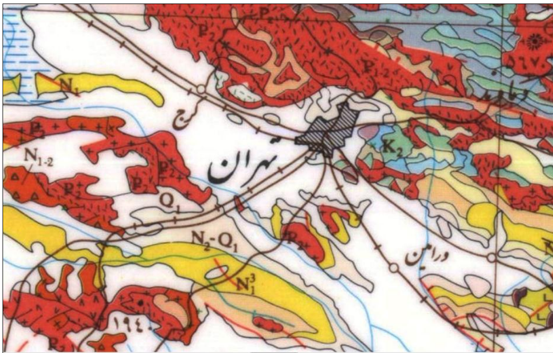
شکل ۵: نقشه زمین‌شناسی جنوب و جنوب شرق تهران به همراه رخساره‌های زمین‌شناسی آن. سطوح قرمز مشخصه وجود رگه‌های آذرین اسیدی هستند (P2)، رنگ زرد، رسوبات میوسن (N3-1) و رنگ سفید، دشت‌های آبرفتی عهد حاضر و رنگ کرم نشان‌دهنده رخساره‌های رسوبی غنی از رس است (N2-Q1).
