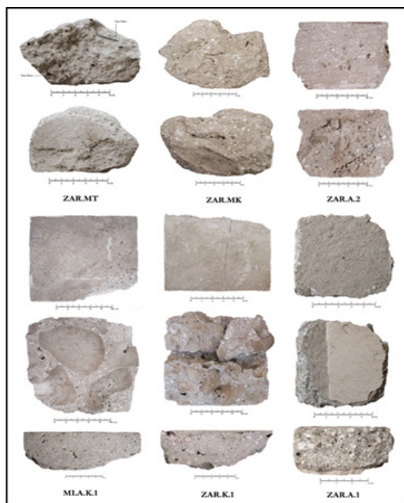
شکل ۵. معرفی تصویری نمونه‌های آندود و ملاط
