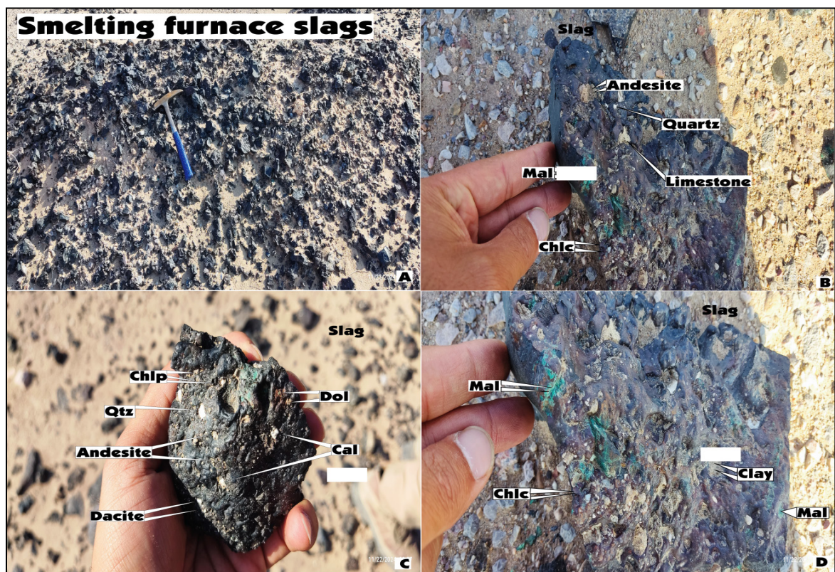
شکل ۸. فراوانی (A) و چند نمونه دستی از سرباره‌ها و قطعات موجود در این بقایای ذوب (B, C, D) که به صورت سنگ شناسی و کانی‌ها مشخص شده‌اند و کانی‌های مس‌دار در آن (B, C) مشخص شده است.
