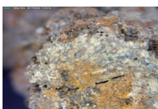
شکل ۱۸. ترک موازی با سطح Figure. 18. Crack parallel to the surface
