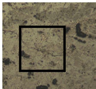
شکل ۲۱. وجود فریت صفحه‌ای نامنظم (بزرگنمایی ۱۰۰ برابر)
