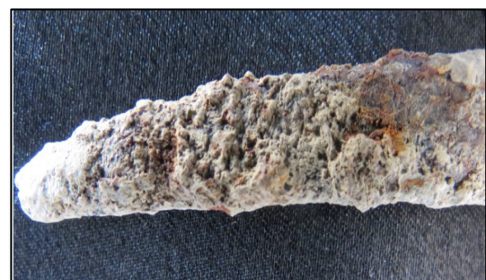
شکل ۸. خوردگی به شکل حفره
