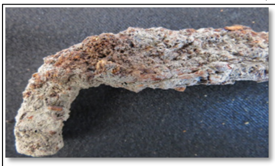
شکل ۹. وجود رسوبات محیطی
