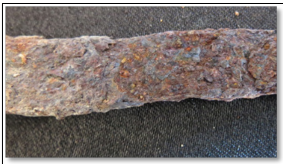
شکل ۱۰. رسوبات پودری نارنجی و زرد رنگ
