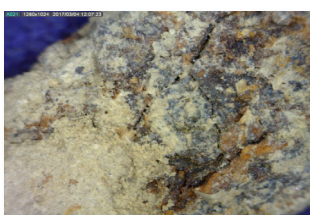
شکل ۱۷. ریزترک‌های موجود در سطح
