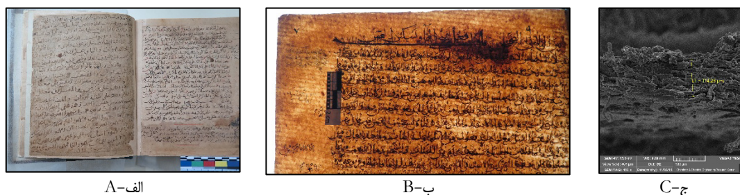
شکل ۱. کاغذ دولت‌آبادی D-۳۴۵: الف) کاغذ به رنگ کرمی؛ ب) عدم پراکندگی یکنواخت خمیر کاغذ، انحراف خطوط
