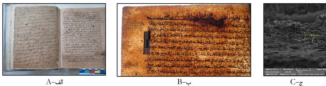
شکل ۱. کاغذ دولت‌آبادی D-345: الف) کاغذ به رنگ کرمی؛ ب) عدم پراکندگی یکنواخت خمیر کاغذ، انحراف خطوط
