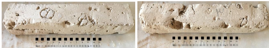
شکل ۵: کلوخه‌های رسی غیرمنسجم (مجومرد، نمونه ۲)
