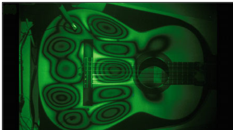
شکل ۷. هولوگرافی تداخل‌سنجی متوسط، لرزش تخته‌ی صوتی گیتار در فرکانس بالاتر از ۱۱۰۰ Hz (a). این روش برای نشان دادن تأثیر طراحی مهاربندی در پشت صفحه‌ی گیتار (b) برای ارزیابی کیفیت صدای گیتارها استفاده شده است (Richardson, 2010, p. 127)
