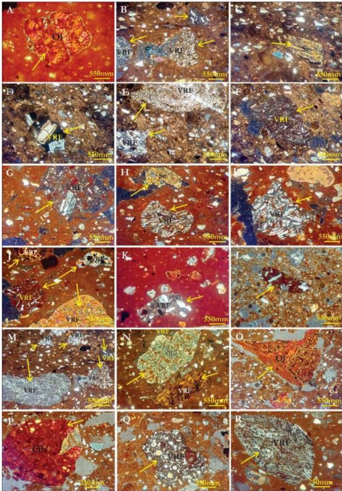
شکل ۶: تصاویر میکروسکوپی (نور پلاریزه متقاطع) از انواع خرده سنگ‌های آذرین (حد واسط و ولکانیکی) (VRF) و قطعات سنگی سربانتینت (Sc) و کانی الیوین (OI) در بزرگنمایی‌های ۵X و ۱۰X.
