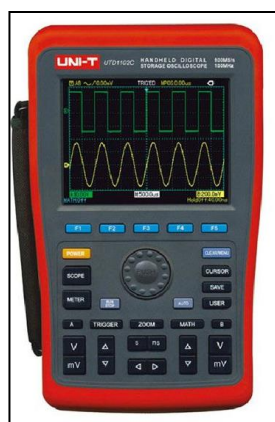
شکل ۶: نمونه یک نوسان‌سنج [18]
